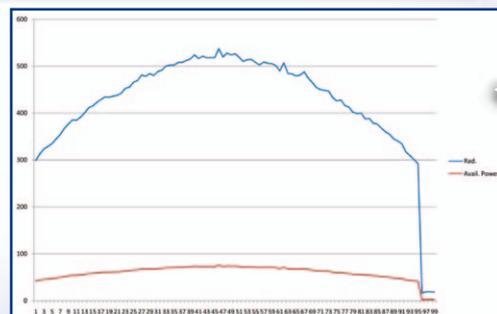
*Beispiel für eine Kurve Strahlungsintensität / Ausgangsleistung*
